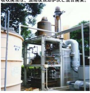
4. 鶏糞焼却炉粉塵除去装置 焼却炉より発生する粉塵の除去のため設置。 80m³/min,280℃ ダスト 1μ以上 90%除去 予冷却塔組み込み。廃液は微生物にて処理 可能。
