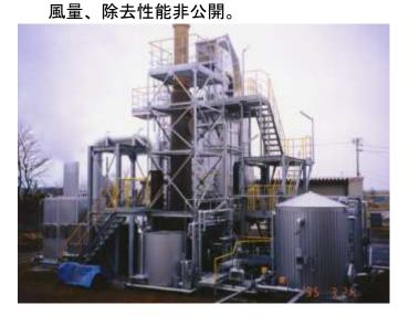
3. 一般ゴミ焼却炉排ガス処理装置 一般ゴミは、比較的有害がスが少ないので粉 塵除去を主たる目的として設計製作納入。 50Nm³/min 粉塵濃度 0.2g/Nm³ 90%以上除去 吸収廃液は、濃縮後焼却炉灰と混合廃棄。
